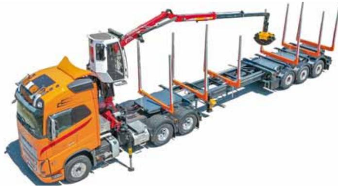
Gespann mit hydraulischer Längenverstellung für Neumann – der Auflieger wiegt 5840 kg, die Zugmaschine 14380 kg.
