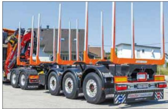
Flexible Lademöglichkeiten: Durch die Längenverstellung von 9 bis 12,5 m ist Auflieger für Abschnitte von 3, 4, 5 oder 6 m sowie für Langholz bis 14 m geeignet. Fotos/Grafik: Riedler
