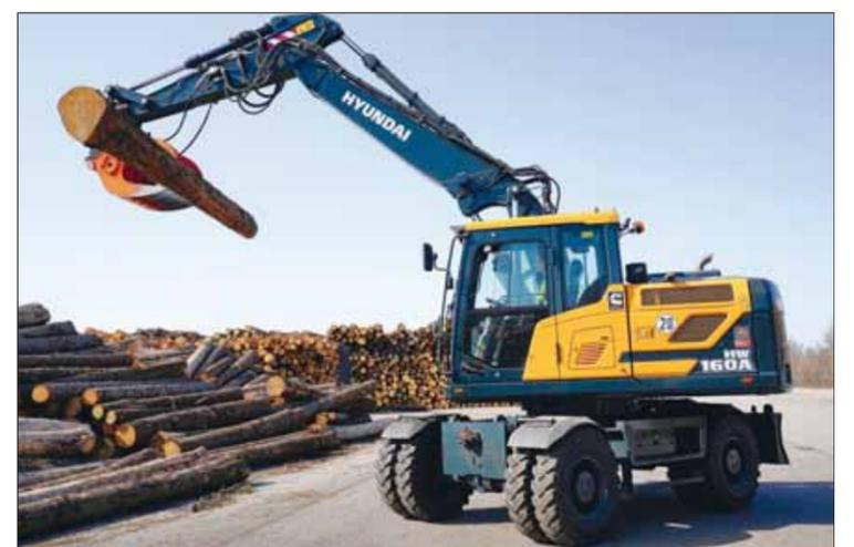
Mobilbagger „HW 160 A“ im Sortiereinsatz bei Biomasse Demmel. Der mit Schild und Verstellausleger ausgerüstete 17-Tonner ist hier im Holzumschlag mit Greifer/Niederhalter im Einsatz. Bild: HCEE
