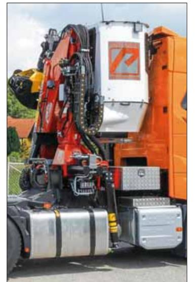
Der Ladekran Penz „15Z“ mit Kabine (hier im Transportzustand) hat eine Reichweite von 9,5 m. Von der Kabine aus kann die Länge des Aufliegers einfach angepasst werden.
